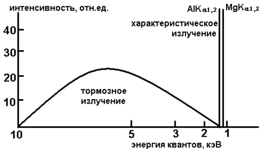
Рис. 6.12. Спектральное распределение интенсивности излучения рентгеновской трубки (алюминиевый или магниевый анод при 10 кВ)
